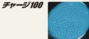
皮膜がふやけて白く浮かび上がるだけでなく、 同時に皮膜破壊を起こし、皮膜に亀裂がはいる。
