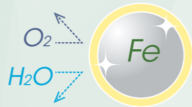
さび止め作用は、「さび」因子の進入・接触を防ぐ
