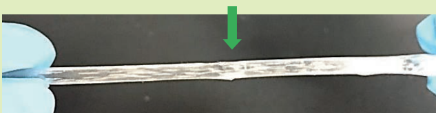
図3 延伸時の状態(中央1箇所切断⇒修復時)
