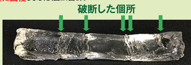
図2 試験後の破断箇所
